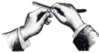
Fig. 586. Modo de efectuar el corte para obtener secciones microscópicas.
